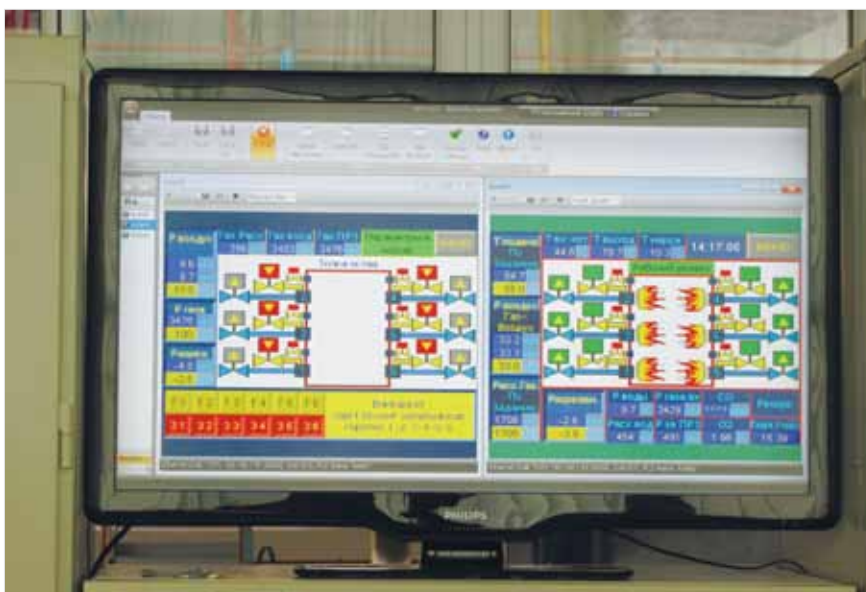
Мнемосхема запуска котла ПТВМ-30
